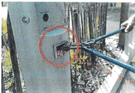
Le coupe boulon permet de sectionner un maillon de chaîne ou à défaut un cadenas d'un diamètre de 10 à 12 mm.
