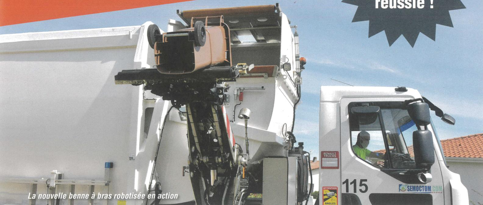
La nouvelle benne à bras robotisée en action
